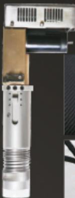
Outil oscillant électronique. Large gamme de lames. Pour matériaux de dureté intermédiaire : carton, nid d'abeille, PVC expansé, cuir.
